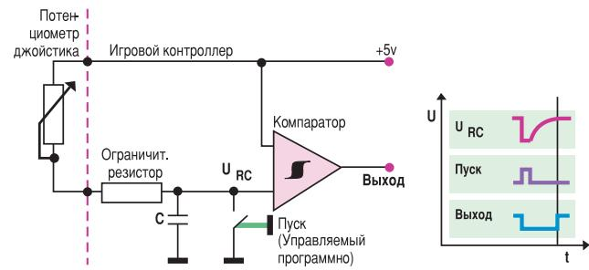
Такая схема имеется в каждом игровом контроллере в четырех экземплярах. Ограничительный резистор препятствует коротким замыканиям. Справа — эпюры сигналов схемы.
